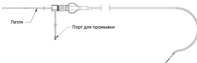
Рисунок 8. Катетер для извлечения основного анкерного фиксатора.
